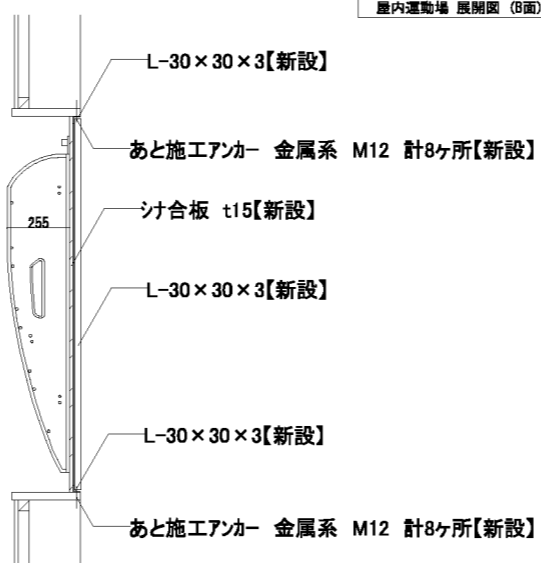
スピーカー新設詳細図 S=1/30 (A3)
