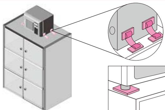
ストラップ式を用いて電子レンジを固定した例
