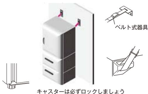
冷蔵庫裏面の取手にベルトを通して、なるべく壁に寄せて固定する。
