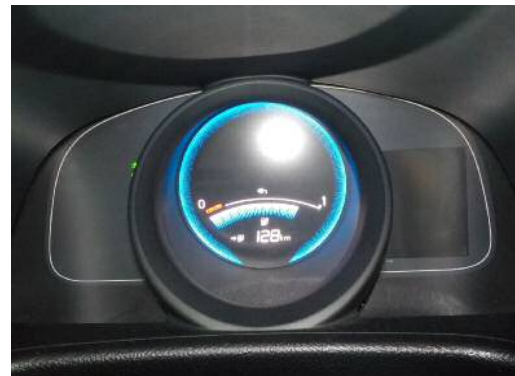
電源供給終了時(バッテリー残量:80%)
