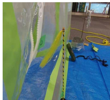
図 4-14 吹流しによる確認
