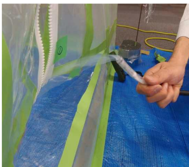
図 4-13 スモークテスターによる確認
