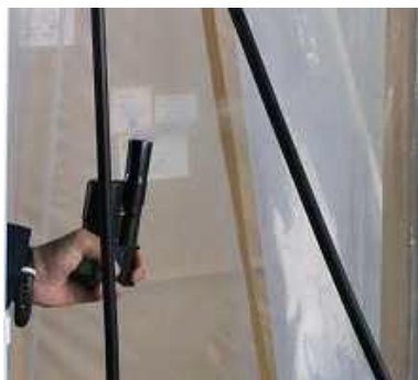
図 4-12 セキュリティゾーンの入口の気流方向の確認（参考：出典 1 P218）
