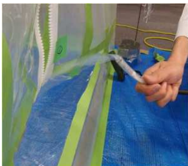
図 4-13 スモークテスターによる確認
