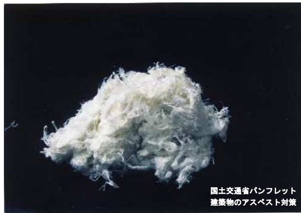
白石綿（クリソタイル）
