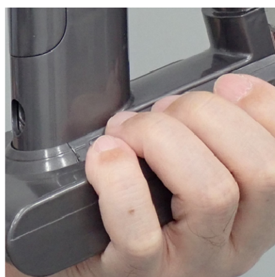
④手のひらをバッテリー底面、指をバッテリー上面にあてがう
