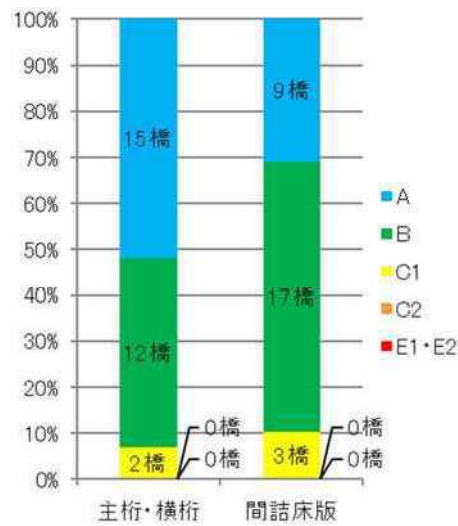
図 3-5 PC橋の損傷状況
