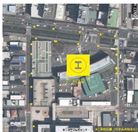
図 23 ヘリポート防災対応基準の場合平面模式図（東西方向離着陸想定）
