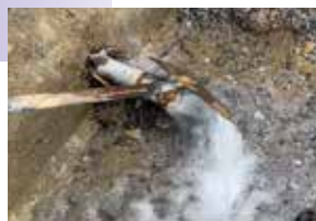
水道管から漏水している様子
