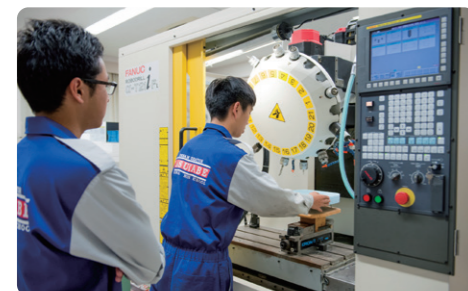
先輩たちが過去にやらなかったことに挑戦してみようという想いから、今年は3DCADとマシニングセンタ(数値制御工作機械)を使ってベースの形を製作することとなった。
