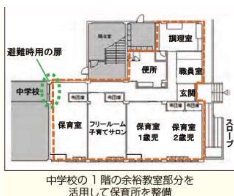
水回りの整備のために床を高くするとともに、 中学校との間の扉を設置
